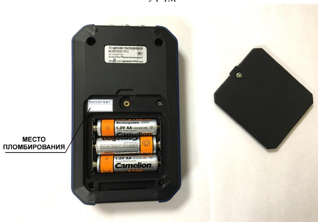
Рисунок 5 – Место пломбирования корпуса толщиномеров ультразвуковых NOVOTEST UT-1-IP
