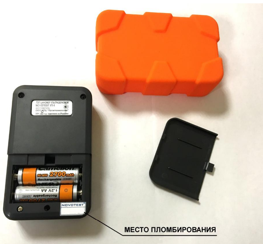
Рисунок 4 – Место пломбирования корпуса толщиномеров ультразвуковых NOVOTEST UT-1M
